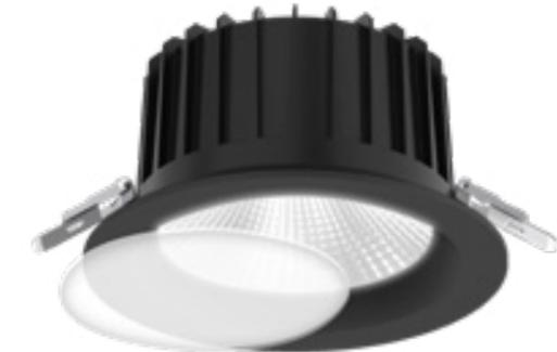
Dieser Einbauspot zeichnet sich durch sein einzigartiges Design mit Reflektor und COB-Hochleistungs-LED-Chip aus. Das Gehäuse aus ADC12-Aluminium bietet eine hervorragende Wärmeableitung. Das LED-Moduldesign ermöglicht eine effiziente Nutzung des Produktangebots und erleichtert den Modulaustausch. Zudem unterstützt es eine umfassende Kompatibilität mit Nicht-Dimmung, Triac-Dimmung, 0-10V und DALI-Dimmung.
